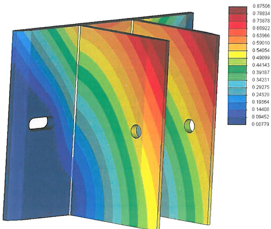
Mapa ugięć konsoli K1/100-150 od obciążenia siłą pionową V=8,95\text{kN}
